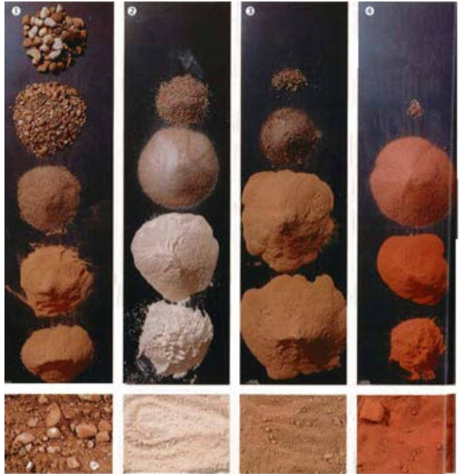
Différents types de terre et leurs composants ©Bâtir en terre
